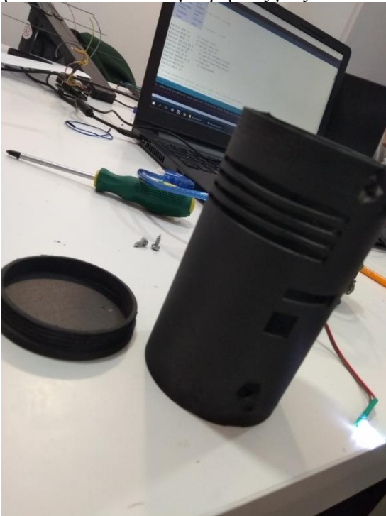
Εικόνα 1: το περίβλημα του CanSat από ανθρακονήμα
